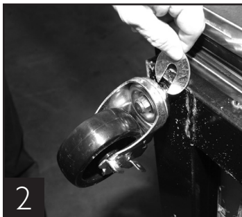
2 Zum Ausrichten die Distanzscheibe zwischen Rolle und Rahmenschiene einlegen.
