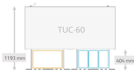
Les meubles TUC 27 et 60 acceptent des bacs GN 1x 1/1 ou 3x 1/3 par tiroir, permettant l'utilisation de bacs 1/6 ou autres configuration. Attention, des barres de répartition (vendues séparément) seront nécessaires.
