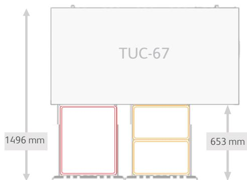
Les produits TUC 67 et 93 disposent d'un système de réfrigération latéral, ce qui permet une capacité plus importante, acceptant un bac 1x 2/1 par tiroir. En conséquence, ces unités sont plus profondes.
