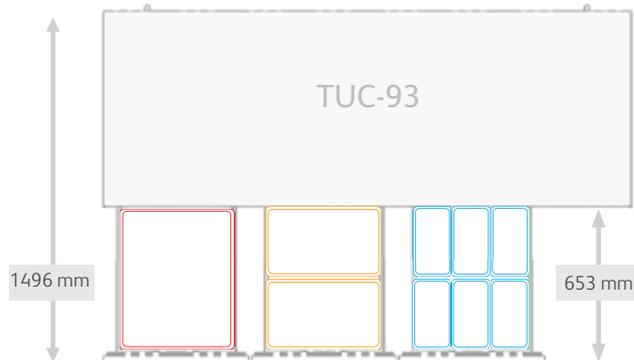
Les comptoirs réfrigérés TUC 67 & 93 sont fournis avec 1 barre de séparation horizontale par tiroir, facilitant l'utilisation des bacs 2x 1/1, 6x 1/3 ou une combinaison des deux types.
