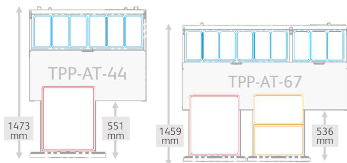
En standard, les tiroirs des tables TPP sont fournis avec 1 barre de répartition horizontale par tiroir, facilitant l'utilisation des bacs GN 2x **1/1**, 6x **1/3**, ou une combinaison des deux types.
