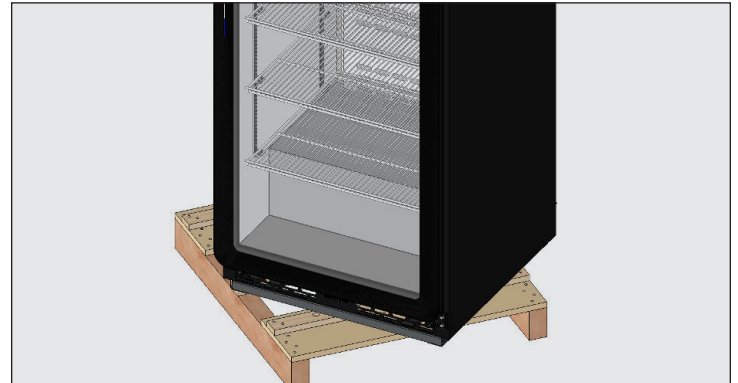
الشكل 4. قم بتدوير الجهاز على المزلاج. عند رفع الوحدة، لا تستخدم المناضد والأبواب/ الأدراج أو الشبكات كنقطة رفع.
